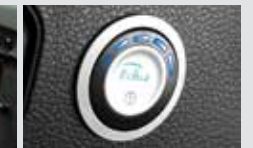
LPG 스위치 LPG 총전량 표시 및 LPG와 가솔린 전환
