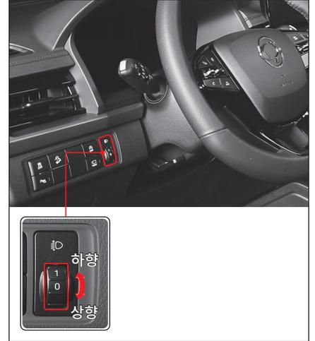
승차 인원 및 적재물의 중량, 무게 중심에 따라 차량의 앞/뒤 기울기가 달라질 수 있습니다. 이때 전조등을 비추는 각도를 조절하여 알맞은 야간 시야를 확보하고, 마주 오거나 앞서가는 차량의 운전을 전조등의 강한 불빛이 방해하지 않도록 조절할 수 있습니다.
