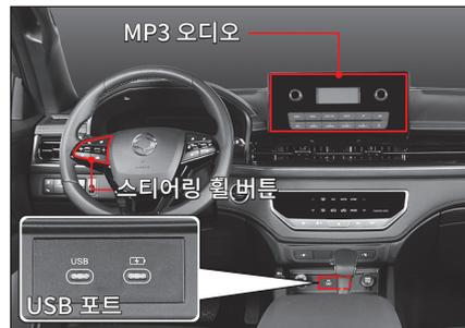
오디오 스위치와 스티어링 휠 스위치를 이용하여 조작할 수 있는 오디오 시스템으로 USB 및 i-Pod 지원 기능이 있습니다.
