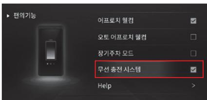
무선충전(Wireless Phone Charger) 시스템은 Qi 표준에 따르는 전자기기(핸드폰)를 무선으로 충전하는 시스템으로 변속기 선택 레버 앞쪽에 있습니다.
