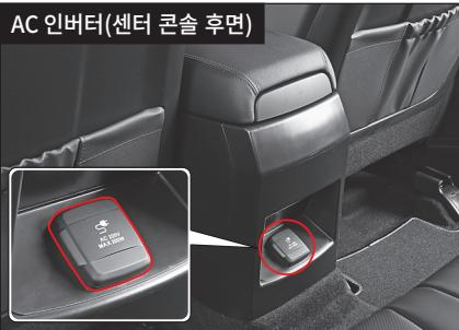
AC 인버터는 차량의 DC 12V 전원을 가정용 전기인 AC 220V(200W)로 변환하여 차량 안에서 노트북이나 스마트폰, 휴대형 TV, 조명 장치, 충전기 등 간단한 전기 제품을 연결해 사용할 수 있도록 해 주는 편의 장치입니다.
