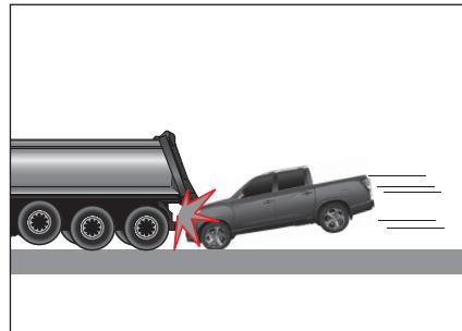
일반적으로 대부분의 운전자는 사고 발생 시에 급제동을 하게 되어 차량의 앞부분이 낮아지는 현상이 발생합니다. 이에 따라 버스나 트럭 등과 같이 차체가 높은 차량과의 사고 시에는 상대 차량의 차체 밑으로 끼어 들어가는 경우가 많이 발생합니다. 이러한 경우에는 에어백이 작동하지 않을 수 있습니다.
