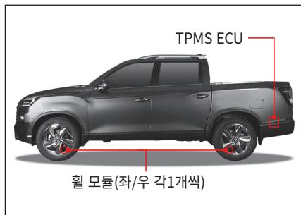
타이어 공기압 모니터링 시스템의 전자 제어 장치는 각각의 휠에 장착된 휠 모듈로부터 공기압과 온도 등의 각종 데이터를 받아 공기압을 계기판에 표시해 줍니다.
