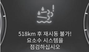
518km 후 재시동 불가!<br>요소수 시스템을 점검하십시오! |
