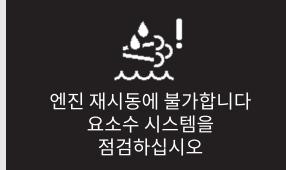
엔진 재시동에 불가합니다<br>요소수 시스템을 점검하십시오!   | <ul style="list-style-type: none"> <li>2차 경고 이후, 주행 가능 거리 0km 상태에서 3차 경고를 표시합니다. 이 경우, 재시동이 불가능합니다.</li> </ul> |
