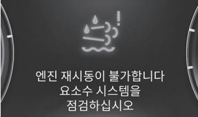
엔진 재시동이 불가합니다<br>요소수 시스템을 점검하십시오!   |
