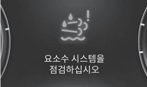
요소수 시스템을 점검하십시오!                    |
