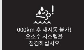
000km 후 재시동 불가!<br>요소수 시스템을 점검하십시오! | <ul style="list-style-type: none"> <li>1차 경고 이후, 주행 가능 거리 800km~0km 상태에서 2차 경고를 표시합니다.</li> </ul>              |
