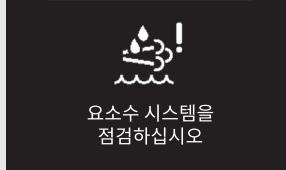
요소수 시스템을 점검하십시오!                    | <ul style="list-style-type: none"> <li>요소수 분사 장치에 결함이 발생한 경우, 50km 동안 1차 경고를 표시합니다.</li> </ul>                 |
