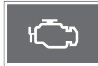
엔진 제어 관련 각종 센서(자동 변속기 포함) 및 장치에 이상이 있을 때 엔진 점검 경고등이 켜집니다.
