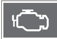
엔진의 연료 시스템이나 주요 전기 장치에 이상이 발생하면 계기판의 엔진 점검 경고등이 켜집니다. 이때, 엔진 구동력이 감소하거나 엔진 시동이 꺼지는 증상이 나타날 수 있습니다. 이와 같은 현상이 나타나면 당사 정비사업장에서 점검 및 정비를 받으시기 바랍니다.
