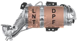
당사의 배출가스 후처리 장치는 LNT+DPF (Lean NOx Trap + Diesel Particulate Filter)입니다. 이 장치에는 질소산화물 저감 장치인 LNT(산화 촉매 장치 기능 포함)와 매연을 포집 및 재생하는 DPF가 일체화되어 있습니다.
