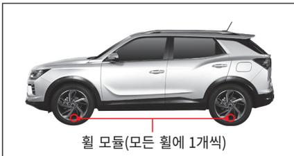
타이어 공기압 모니터링 시스템의 전자 제어 장치는 각각의 휠에 장착된 휠 모듈로부터 공기압과 온도 등의 각종 데이터를 받아 공기압을 계기판에 표시해 줍니다.
