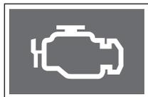
엔진의 연료 시스템이나 주요 전기 장치에 이상이 발생하면 계기판의 엔진 점검 경고등이 켜집니다. 이때, 엔진 구동력이 감소하거나 엔진 시동이 꺼지는 증상이 나타날 수 있습니다.
