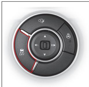
스위치를 누르면 ESP 기능이 해제 (계기판 ESP OFF 표시등 점등) 되고, 다시 한번 스위치를 누르면 ESP 기능이 회복됩니다.
