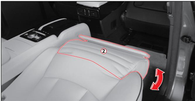
1. 레그 레스트 틸트 스위치 ①번을 위로 당겨 레그 레스트 ②가 적절한 위치까지 상승되도록 하십시오. 레그 레스트 틸트 스위치를 작동하는 만큼 이동하게 되어 있습니다.(레그 레스트 틸트 스위치 ①번을 누르면 레그 레스트 ②는 아래로 내려 갑니다.)
