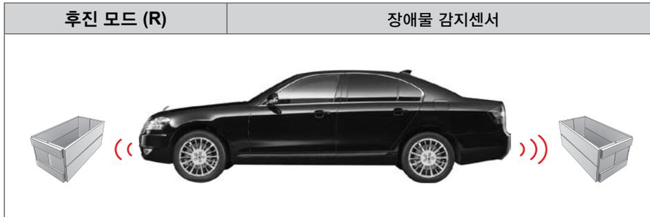
차량 후진 모드 (R)에서는 프런트 및 리어 장애물 감지 센서가 작동
