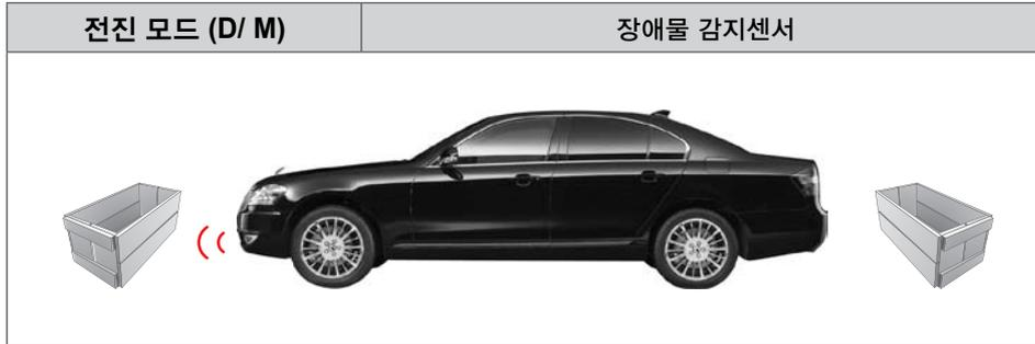
차량 전진 모드 (D 또는 M)에서는 프런트 장애물 감지 센서가 작동
