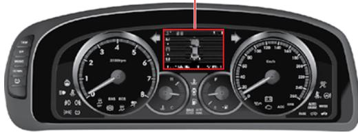
장애물 감지 시스템 또는 센서 이상 발생시 계기판 전시창에 센서 점검표시가 나타나고 시스템 점검사항에도 표시 됩니다.
