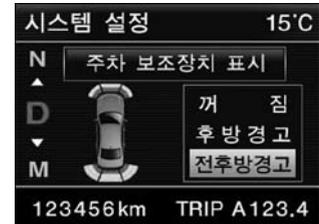
전/ 후방 장애물 감지센서 작동 상태 모두 계기판 전시
