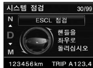
ESCL (Electric Steering Column Lock)은 기계적인 스티어링 핸들 잠금 장치가 아니라 전기적인 신호로 스티어링 핸들을 고정(잠금)하는 장치로 관련 시스템에 이상이 있을 경우 위와 같은 메시지가 계기판에 전시됩니다.(별도의 경고등 없음)
