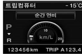
10km/h 이상 주행 시 0.6초 동안에 입력된 연료 및 이동거리 데이터를 기준으로 약 0.2초 마다 연비를 보정 및 산출하여 전시합니다.
