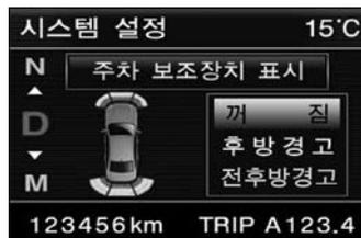
차량 주차보조 시스템의 작동을 선택하는 화면으로 꺼짐 선택시 계기판에 장애물과의 상태가 계기판에 표시되지 않습니다. 단, 부저에 대한 경고는 계속됩니다.
