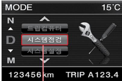
시스템 점검은 차량 주요 시스템의 이상 유무 및 조치사항을 계기판에 문자로 나타내 주는 항목입니다.
