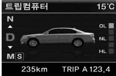
EAS 스위치 (UP/ DOWN) 조작이나 차량 속도 변화에 의해 계기판 전시창에 EAS의 작동 상태가 전시됩니다. 각 상태의 전환 가능 조건은 차속에 따라 다르며 EAS시스템에 이상이 발생할 경우 **EAS** 경고등이 점등 됩니다. 상세 내용은 4단원을 참조하십시오.
