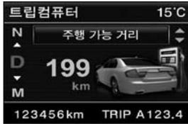
현재 남아있는 연료량을 기준으로 차량 주행 가능 거리를 대략적으로 표시
