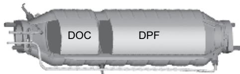
매연 저감 장치에는 DOC(Diesel Oxydation Catalyst)와 DPF(Diesel Particulate Filter)가 있습니다.
