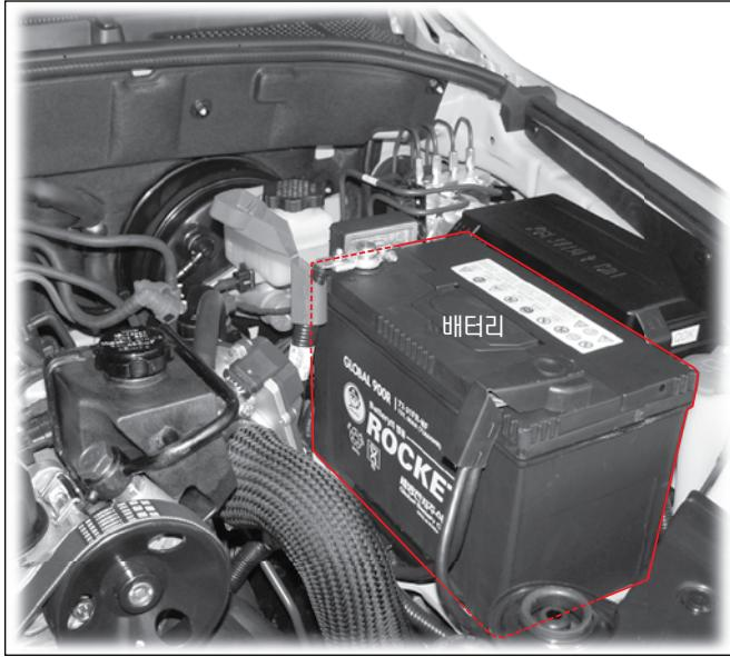
차량 주행중에 계기판의 충전 경고등 (■)이 점등되면 배터리를 포함하는 차량의 충전 시스템에 이상이 있는 것이므로 당사 정비사업장에서 점검 및 정비를 받으십시오.
