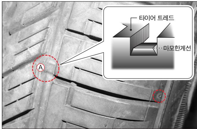
타이어 측면의 표시 부분을 따라 타이어 접촉면의 타이어 마모 상태를 점검하십시오. 마모 트레드(A)가 마모 한계선 이하로 내려가기 전에 타이어를 교환하십시오.
