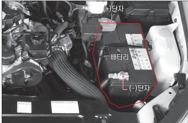
차량 주행중에 워닝박스의 충전 경고등(■)이 점등되면 배터리를 포함하는 차량의 충전 시스템에 이상이 있는 것으로 당사 정비사업장에서 점검 및 정비를 받으십시오.
