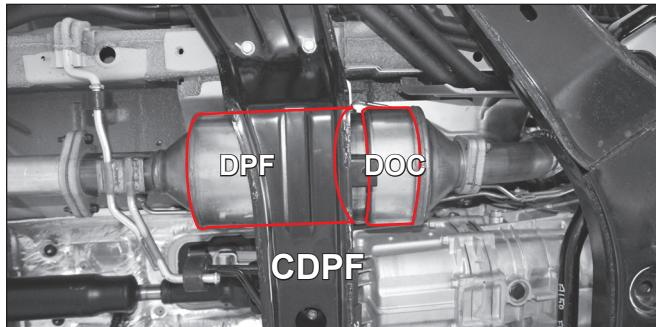
매연 저감 장치에는 DOC(Diesel Oxidation Catalyst)와 DPF(Diesel Particulate Filter)가 있습니다.
