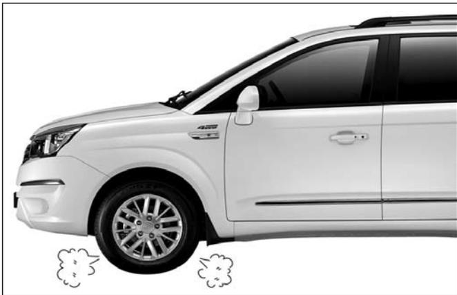
주행 중 타이어가 펑크나면, 스티어링 휠을 꼭 움켜잡고 가속 페달에서 발을 떼면서 서서히 감속시킨 후 가볍게 브레이크 페달을 밟아 차량을 안전한 장소에 정차시키십시오. 이후 펑크난 타이어를 차량에 비치된 스페어 타이어 또는 타이어 서비스 키트를 이용하여 수리하십시오. [타이어 서비스 키트 사용 방법 참조]
