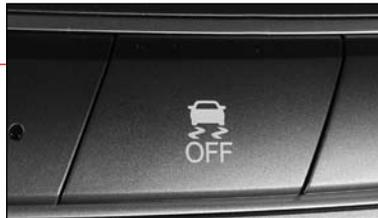
스위치를 누르면 ESP 기능이 해제(워닝박스 ESP OFF 표시등 점등)되고, 다시한번 스위치를 누르면 ESP 기능이 회복(워닝박스 ESP OFF 표시등 소등)됩니다.
