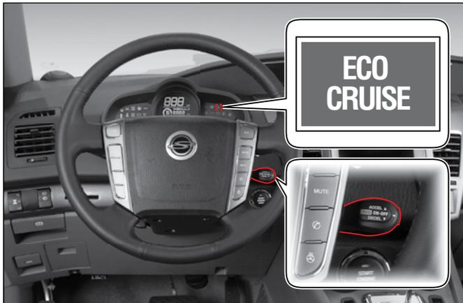
크루즈 컨트롤 시스템(Cruise control system)은 운전자가 원하는 주행 속도를 설정해 놓으면 가속페달을 밟지 않아도 자동적으로 속도를 유지 하면서 주행하는 시스템입니다. 크루즈 컨트롤 작동스위치는 스티어링 핸들 우측 하단부에 장착 되어 있으며, 스위치 작동시 워닝박스에 **ECO CRUISE** 램프가 점등됩니다.
