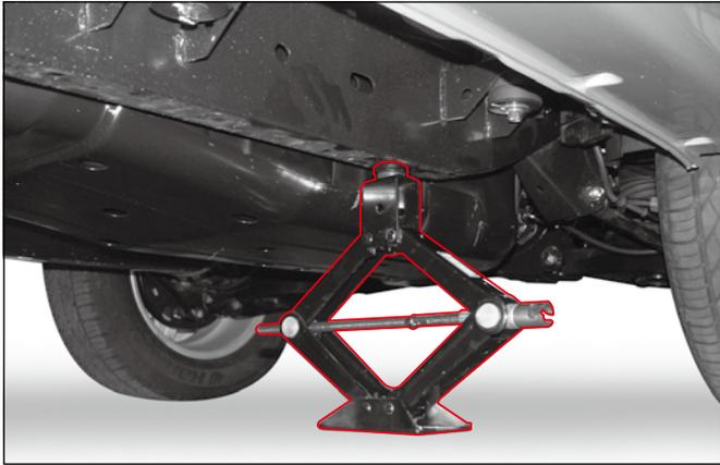
3. 잭의 바닥면과 지면이 완전히 닿도록 잭을 설치한 후 잭을 작동시켜 잭의 상부 플레이트가 프레임 잭 설치 포인트에 닿도록 하십시오.
