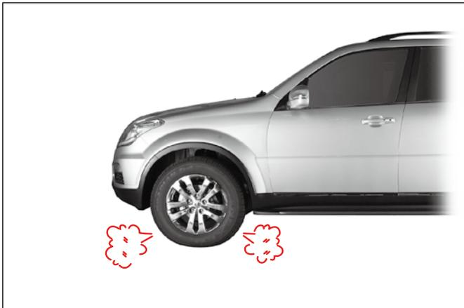
주행중 타이어가 펑크나면, 스티어링 휠을 꼭 움켜잡고 가속 페달에서 발을 떼면서 서서히 감속시킨 후 가볍게 브레이크 페달을 밟아 차량을 안전한 장소에 정차시키십시오. 이후 펑크난 타이어를 구비된 임시용 타이어로 교환 하거나 서비스 키트를 이용하십시오. [“서비스 키트(타이어 수리 용구) 사용 방법” 및 “임시용 타이어\* 교체” 내용 참조]
