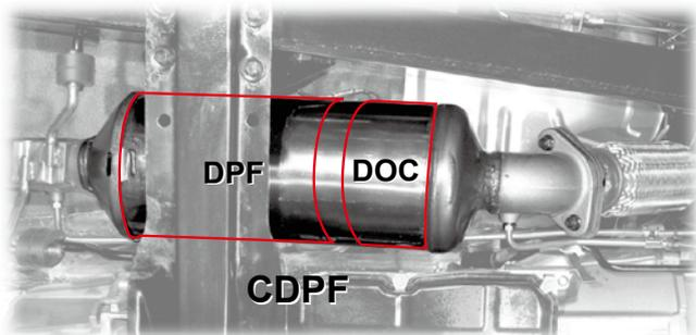
매연 저감 장치에는 DOC(Diesel Oxidation Catalyst)와 DPF(Diesel Particulate Filter)가 있습니다.
