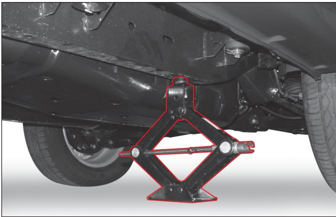
2. 잭의 바닥면과 지면이 완전히 닿도록 잭을 설치한 후 잭을 작동시켜 잭의 상부 플레이트가 프레임 잭 설치 포인트에 닿도록 하십시오.
