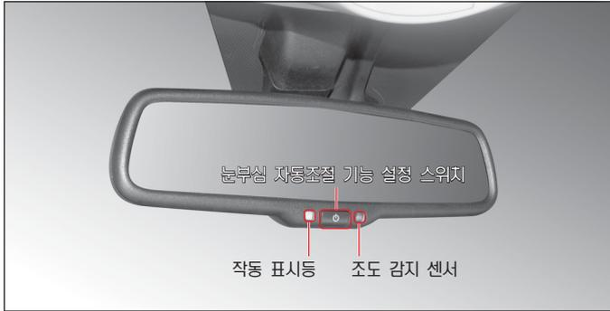
눈부심 자동조절 기능 설정 스위치를 누르면(작동 표시등 점등) 뒷차량 전조등 밝기에 따라 반사율을 자동으로 조절하여 운전자의 눈부심을 방지할 수 있습니다. 눈부심 자동조절 기능이 설정된 상태에서 스위치를 다시 한번 누르면 작동 표시등이 소등되면서 기능이 해제됩니다.
