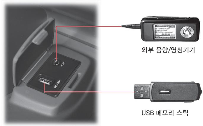
USB 메모리 스틱에 저장되어 있는 음악파일을 재생시키거나 외부 음향기기를 이용하여 차량 스피커를 통해 음악을 감상하고자 할때 위와 같이 연결하여 사용하십시오
