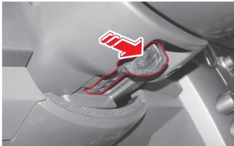
스티어링 휠 고정 해제 레버를 우측으로 밀고 있는 상태에서 스티어링 휠의 높이를 조정합니다. 휠 높이를 적당한 위치로 조정하고 레버를 놓으면 스티어링 휠이 고정됩니다. 휠이 고정되었는지 움직여 확인하십시오.
