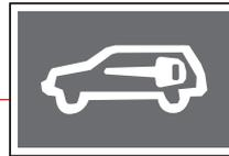
이모빌라이저 키와 엔진 컨트롤 유닛 간에 통신중일 때에는 계기판의 이모빌라이저 작동 표시등이 점등됩니다. 통신완료(시동완료)후에는 소등됩니다. 이모빌라이저 작동표시등이 점멸할 경우에는 시스템에 이상이 있는 것이므로 점검 및 정비를 받으십시오.
