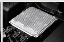
LPG ECU LPG전용 ECU로서 가솔린 ECU와 액체형태의 LPG가스를 협업하여 2개 연료를 최적화
