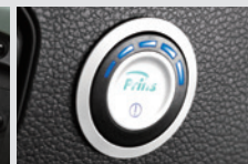
LPG 스위치 LPG 총전량 표시 및 LPG와 가솔린 전환
