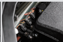
LPG 인젝터 엔진 인젝터에 LPG를 분사하는 장치
