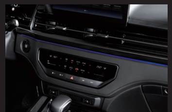
블랙 포인트 인테리어 (터치식 공조 컨트롤러/엔진 시동·정지 버튼 스위치 링 / 대쉬보드 수평형 가니쉬)
