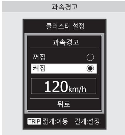
속도 경고를 설정(60, 70, 80, 90, 100, 110, 120)해 놓고 주행시 해당 속도에 도달하면 계기판의 엔진 회전수 게이지 및 차량 속도 게이지 컬러 조명(그래데이션)부분이 점멸됩니다.
