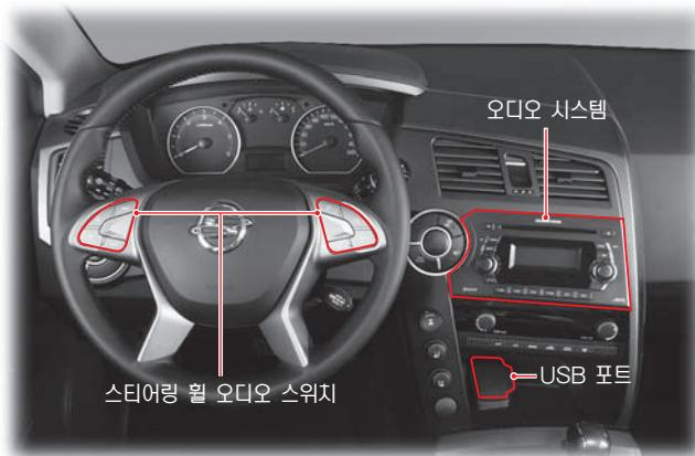
오디오 시스템 패널의 스위치 및 스티어링 휠의 오디오 스위치를 이용하여 오디오 시스템을 조작할 수 있습니다.
