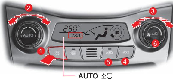
수동 모드에서는 작동 표시창에 **AUTO** 가 점등되어 있지 않는 상태이며, 온도 조절 다이얼, 풍량 조절 다이얼, 모드선택 스위치(송풍 방향 스위치), 에어컨디셔너 작동 스위치, 내/외기 선택 스위치, 디프로스터 스위치를 각각 조정해 주면서 원하는 실내 상태를 설정해 주어야 합니다.
