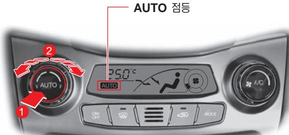
자동 작동 상태(자동 모드)에서 내/외기 선택 스위치, 풍량 조절 다이얼, 모드선택 스위치(송풍 방향 스위치), 에어컨디셔너 작동 스위치, 디프로스터 스위치를 눌러 원하는 송풍 방향 상태로 설정하면 **AUTO** 가 소등되면서 수동 모드로 전환됩니다.
