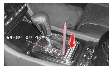
선택 레버를 **P**위치에서 다른 위치로 이동하기 위해서는 시동키가 **ON** 위치에 있고 브레이크 페달을 밟은 상태여야 합니다. 시동 키 이유치 에서 브레이크 페달을 밟았음에도 불구하고 레버가 P에서 이동되지 않 으면 다음과 같이 수동으로 이동하십시오.
