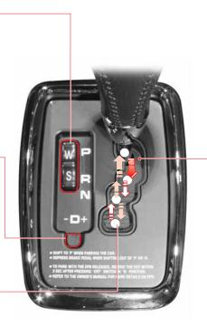
**P**위치에서 다른 위치로 이동하려면 시동 키 ON 상태에서 브레이크 페달 을 밟아야 이동 가능합니다. 반드시 브레이크 페달 을 밟아야 선택레버 이 동 가능 안전을 위해 브레이크 페달을 밟은 상태에서 선택레버를 이동해야함 브레이크 페달을 밟지 않고 선택레버 이동이 가능함
