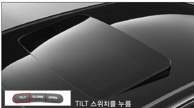
선루프가 완전히 닫혀져 있는 상태에서 TILT 스위치를 누르면 선루프 뒷부분이 올라가는 틸트-업 (TILT-UP) 상태가 되고 CLOSE 스위치를 누르면 틸트-다운 (TILT-DOWN) 상태가 됩니다.
