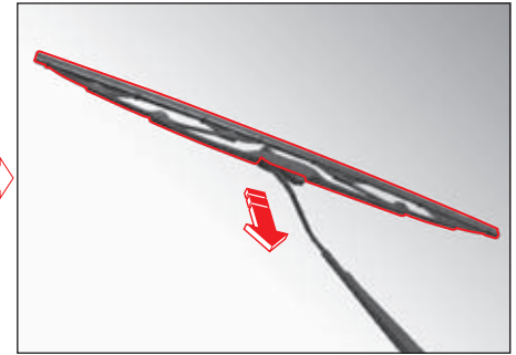
3. 와이퍼 블레이드를 아래로 밀면서 와이퍼 암에서 빼내십시오. 4. 새 와이퍼 블레이드를 끼우십시오. 5. 와이퍼 암을 내립니다.
