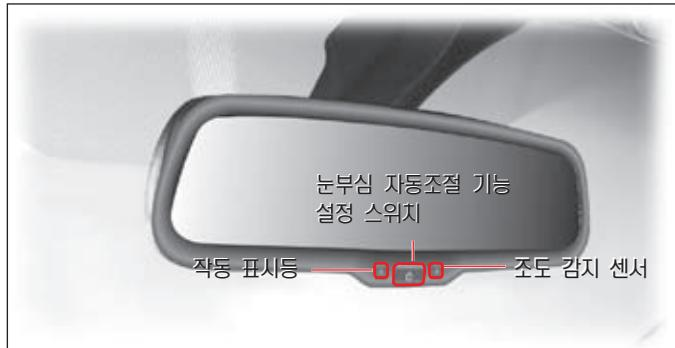
눈부심 자동조절 기능 설정 스위치를 누르면(작동 표시등 점등) 뒷차량 전조등 밖기에 따라 반사율을 자동으로 조절하여 운전자의 눈부심을 방지할 수 있습니다. 눈부심 자동조절 기능이 설정된 상태에서 스위치를 다시 한번 누르면 작동 표시등이 소등되면서 기능이 해제됩니다.
