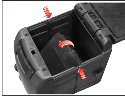
2. 트레이 바닥에 있는 받침대를 들어 올리고 트레이 양옆면을 안쪽으로 밀어 트레이 앞 하단부의 고정부위가 빠지도록 하십시오.
