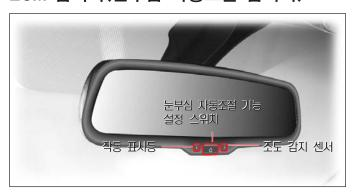
눈부심 자동조절 기능 설정 스위치를 누르면(작동 표시등 점등) 뒷차량 전 조등 밝기에 따라 반사율을 자동으로 조절하여 운전자의 눈부심을 방지할 수 있습니다. 눈부심 자동조절 기능이 설정된 상태에서 스위치를 다시 한번 누르면 작동 표시등이 소등되면서 기능이 해제됩니다.
