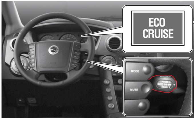
크루즈 컨트롤 시스템 (Cruise control system)은 운전자가 원하는 주행 속도를 설정해 놓으면 가속페달을 밟지 않아도 자동적으로 속도를 유지하면서 주행하는 시스템입니다. 크루즈 컨트롤 작동스위치는 스티어링 핸들 우측 하단부에 장착 되어 있으며, 스위치 작동시 계기판에 ECO CRUISE 램프가 점등됩니다.
