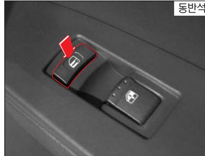
차량 도어와 테일게이트가 잠겨져 있는 상태(**LOCK**)에서 스위치를 누르면 잠김상태가 해제됩니다. 잠김이 해제된 상태(**UNLOCK**)에서 스위치를 누르면 잠김상태가 됩니다.
