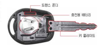
이모빌라이저 장착 차량에는 리차저블 (충전)기능이 적용되어 있으므로 시동을 걸면 키 내부의 배터리가 자동으로 충전됩니다.
